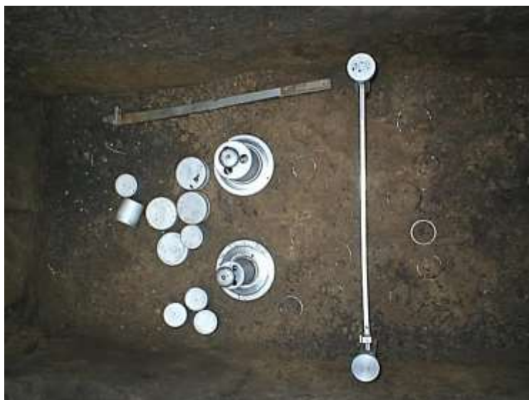
Рис. 4. Отбор проб грунта в траншее
