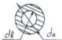
Рисунок 5 – Кольцевое сечение вала
