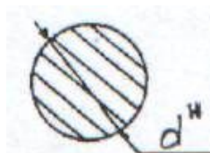
Рисунок 4 – Сплошное сечение вала
