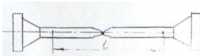
Рисунок 2 - Образец после испытаний
