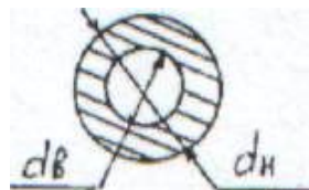
Рисунок 3- Сечение вала и внутренней полости
